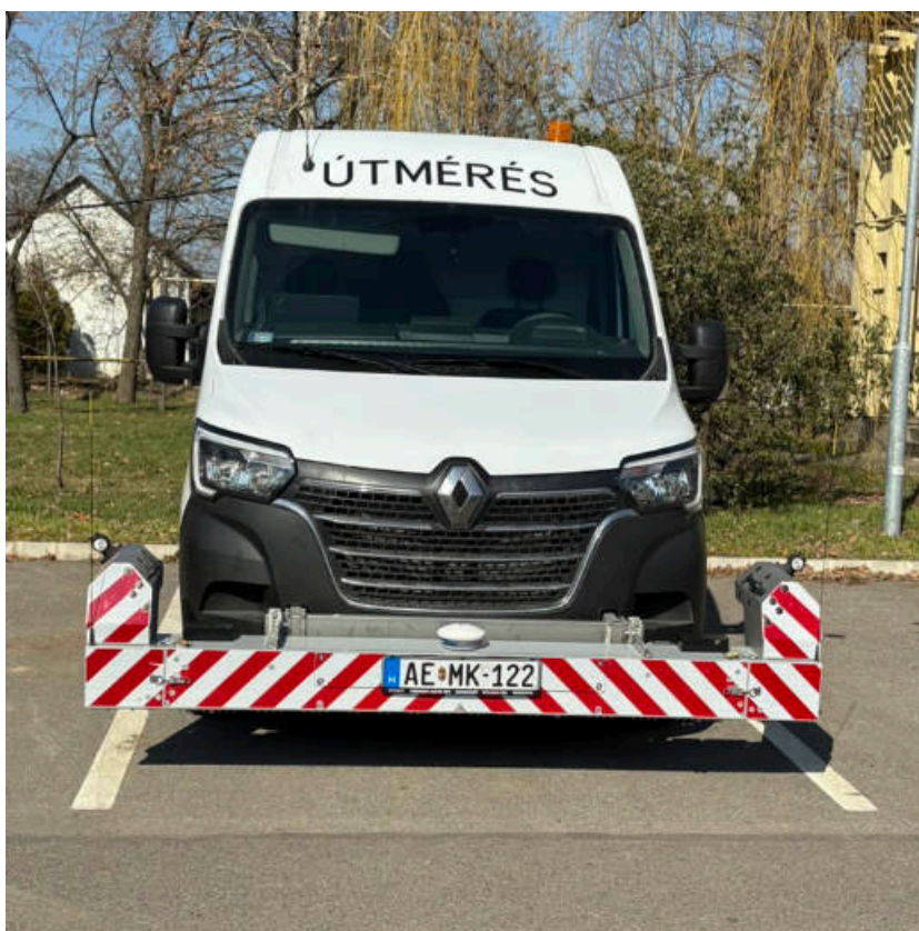
1. ábra: A Széchenyi István Egyetem Útépítési Laboratóriumának mérőkocsija (KLÁRA)
