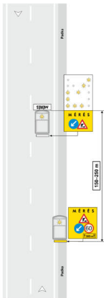
8. ábra: H4-es forgalomkorlátozási ábra (forrás: Magyar Közút NZrt.)
