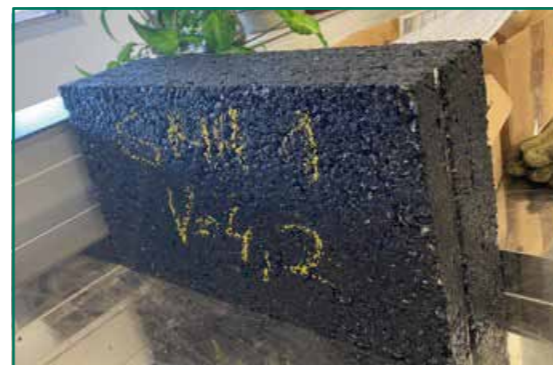
2. ábra: SMA 11 (mI) PmB 25/55-65 szegmenstömörítővel készített lappróbatest.
