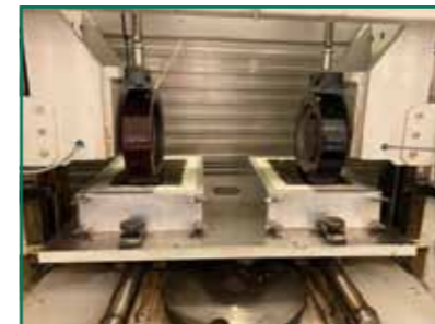
3. ábra Keréknyomképződés vizsgálati berendezés -kiskerekű eszköz.
