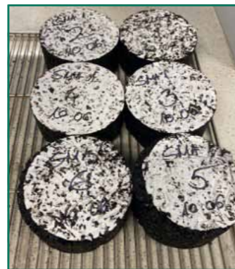
1. ábra: SMA 11 (mI) PmB 25/55-65 gyárral készített henger alakú próbatest.
