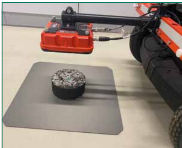
15. ábra PaveScan mérés.
