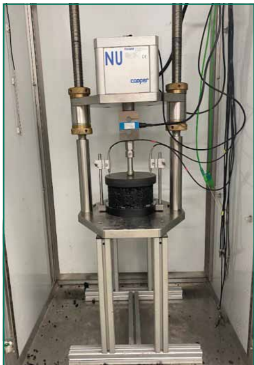
7. ábra NU klímasekrény, dinamikus kúszásvizsgáló modullal.
