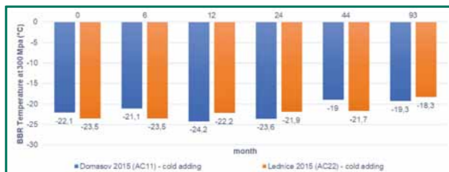
6. ábra: Kritikus hőmérséklet S = 300 MPa hajlítási merevséggel 0, 6, 12, 24, 44 és 93 hónap után
