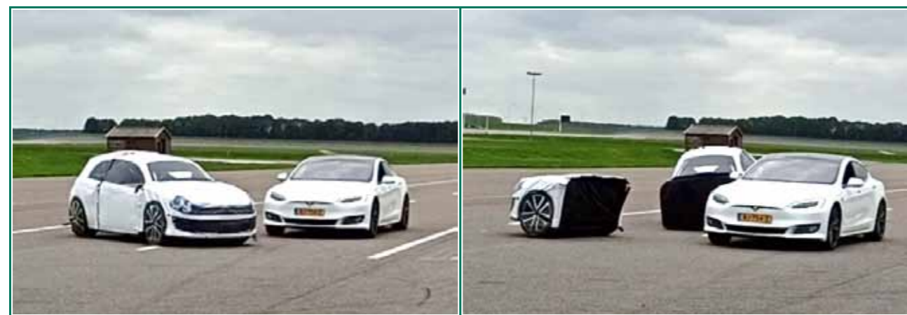
1. ábra: Tesla ütközése a szivacsautóval a lelystad-i tesztpályán
