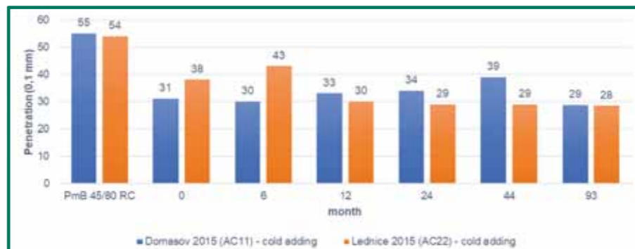
4. ábra: A friss PmB 45/80 RC és a visszanyert kötőanyag penetrációja 0, 6, 12, 24, 44 és 93 hónap után.
