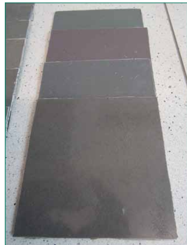
3. ábra Az útépitőipari por és műanyag hulladék felhasználásával készült különböző színű kompozit minták, melyek felülete tetszőlegesen megválasztható
