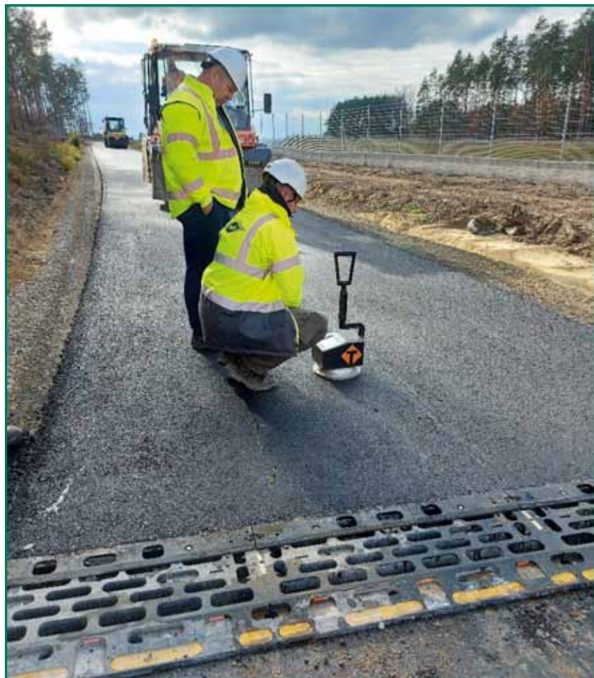
4. kép Tömörésmérés a ReBe csatlakozástól 1 m távolságra (saját fénykép)
