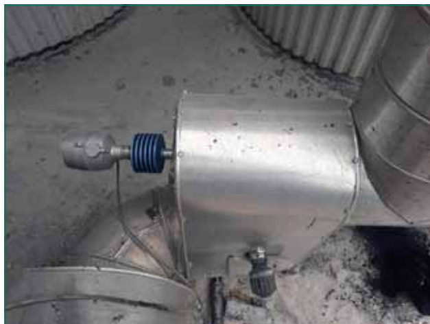
2. ábra A keverőtelepen beszerelt viszkoziméter
