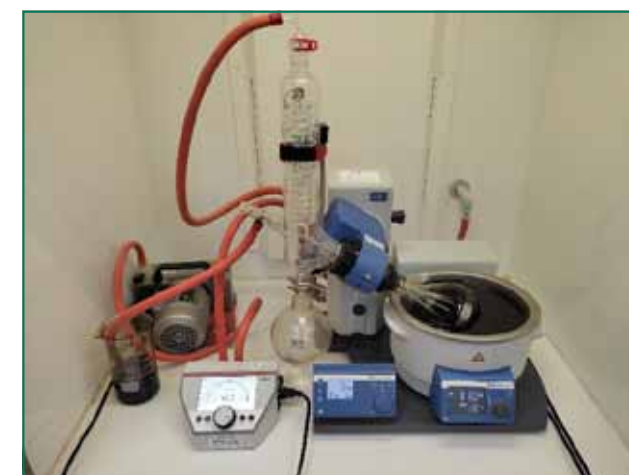
2. ábra: Forgó bepárló beeresztőcsappal, bitumen visszanyeréshez
