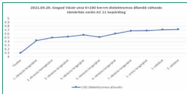
11. kép: Dielektromos állandó tömörítő hengerjáratonként bekövetkező változása
