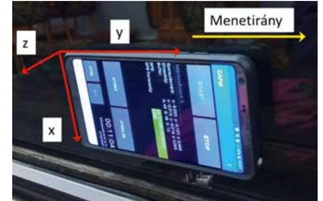
6. ábra. Célszerű mérési elrendezés vasúti járművön
