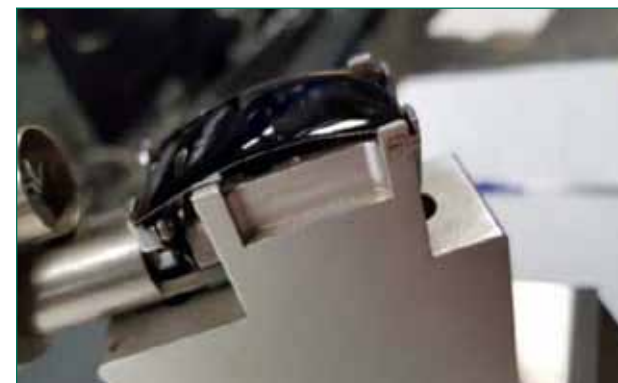
3. ábra: Fraass-töréspont vizsgálati minta
