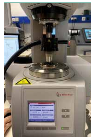
5. ábra: DSR készülék a BTSV és MSCRT mérésekhez
