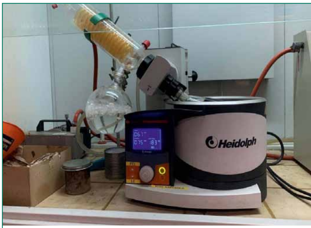
2. ábra: Bitumen visszanyerése
