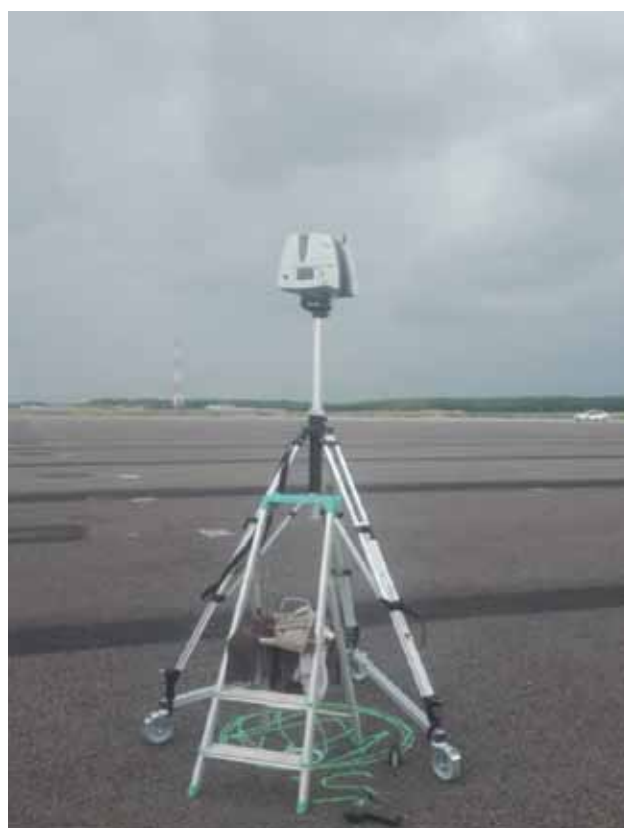
2. ábra: Lézerszkenneléshez használt Leica ScanStation
