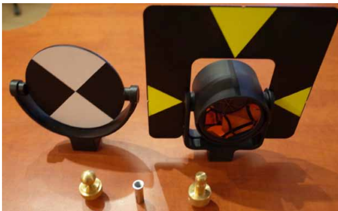
4. ábra: A DP aszfaltrétegeken tájékozáshoz használt rendszer: fűrt persely, csavar és körprizma
