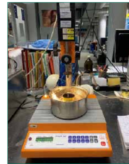
6. ábra: A vizsgálatokhoz használt penetrométer
