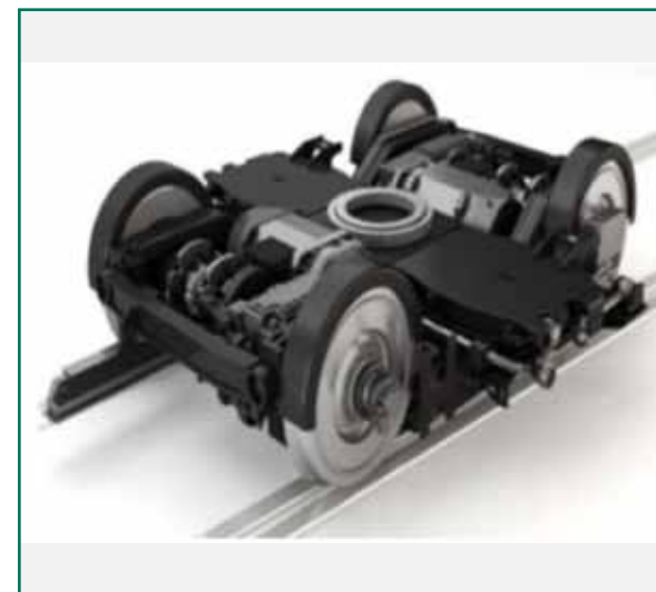
1. ábra. Hagományos, kocsiszekevény alatt elforduló forgóváz [1]
