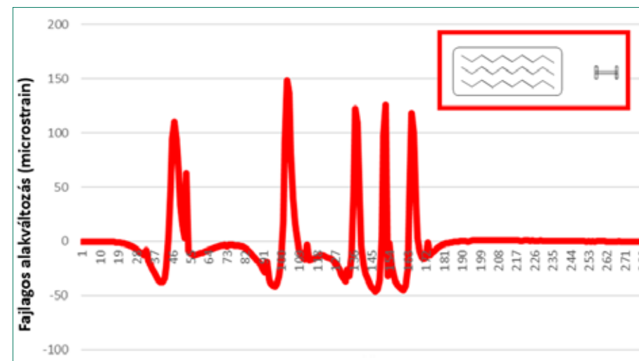
4. ábra: Fajlagos alakváltozás keréknyommal párhuzamos szenzorban
