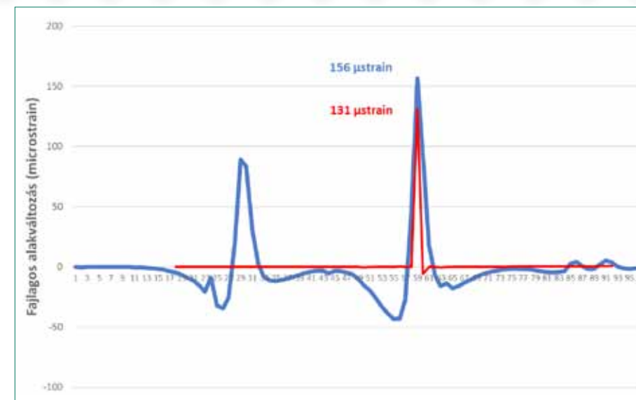
8. ábra: Fajlagos alakváltozás FWD és kéttengelyes tehergépjármű áthaladás hatására
