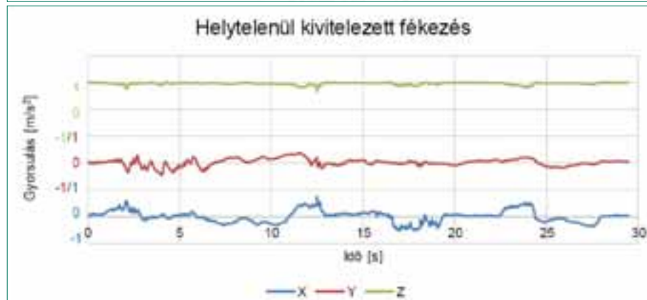
3-4. ábra A helyesen kivitelezett progresszív fékezés ábráján egyértelműen kivehető mikor történt a fékezés, míg az "ad hoc" fékezés egy elnyújtottabb, kevésbé határozott megállás képét mutatja. Mindez természetesen féktávolságban is mérhető érték (saját mérés)
