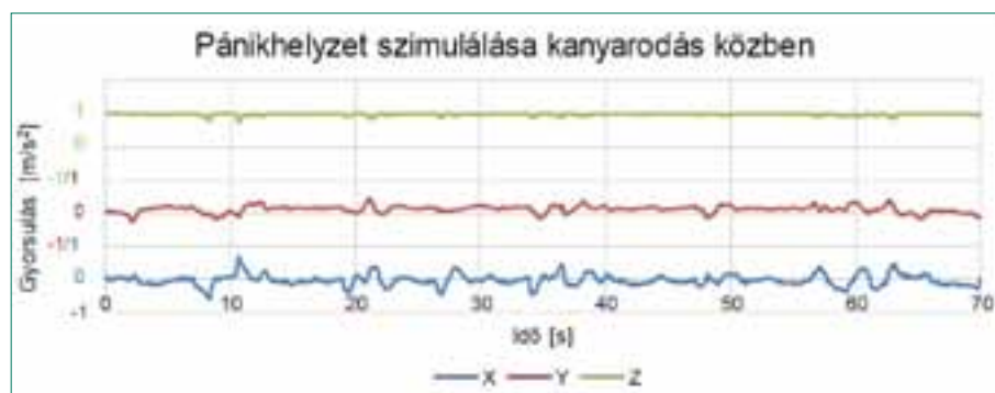
1-2. ábra A mérések alapján látható, hogy jelentős mértékben nő a kanyarodási stabilitás abban az esetben, ha a motoros helyesen kezeli a kezelőszerveket és tisztában van a helyes ülőpozícióval (saját mérés)
