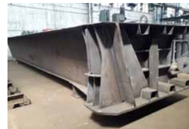
5. ábra: Fél merevítőtartó támaszkeresztmetszetnél
