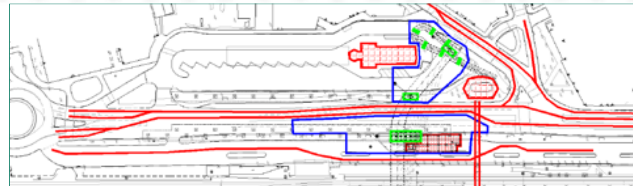
11. ábra: Kötöttségek (piros) és a rendelkezésre álló munkaterület (kék) az alépítményi munkák (zöld) készítésekor
