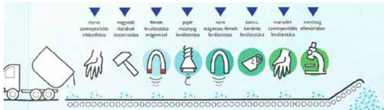
2. ábra: Hulladékuveg feldolgozásának folyamata (www.maltha.hu prospektus)
