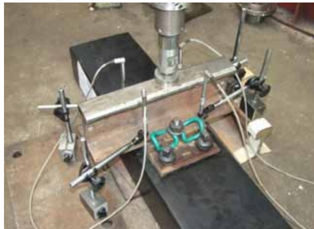
5. ábra: STRAILway alj statikus rugalmasságának mérése
