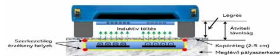
9. ábra: elektromos töltőinfrastruktúra beépítése a burkolatba [16]
