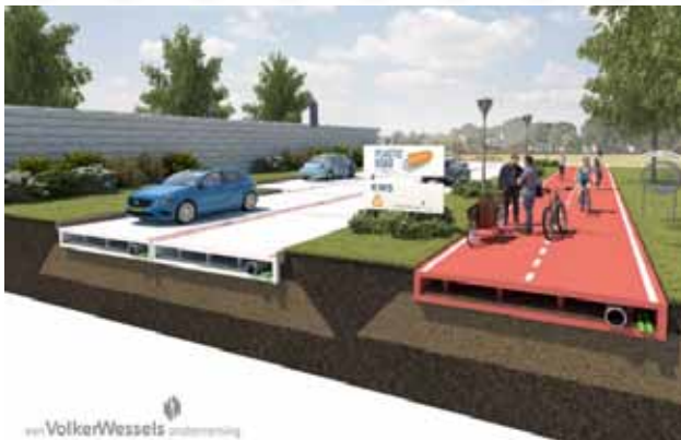
4. ábra: a VolkerWessels műanyag, előregyártott pályaszerkezete [8]
