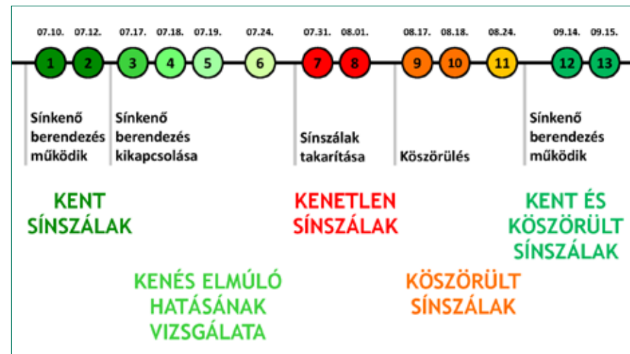
3. ábra: Megvalósult méréssorozat, mérési napok és az azokhoz tartozó sínzsalak állapotai
