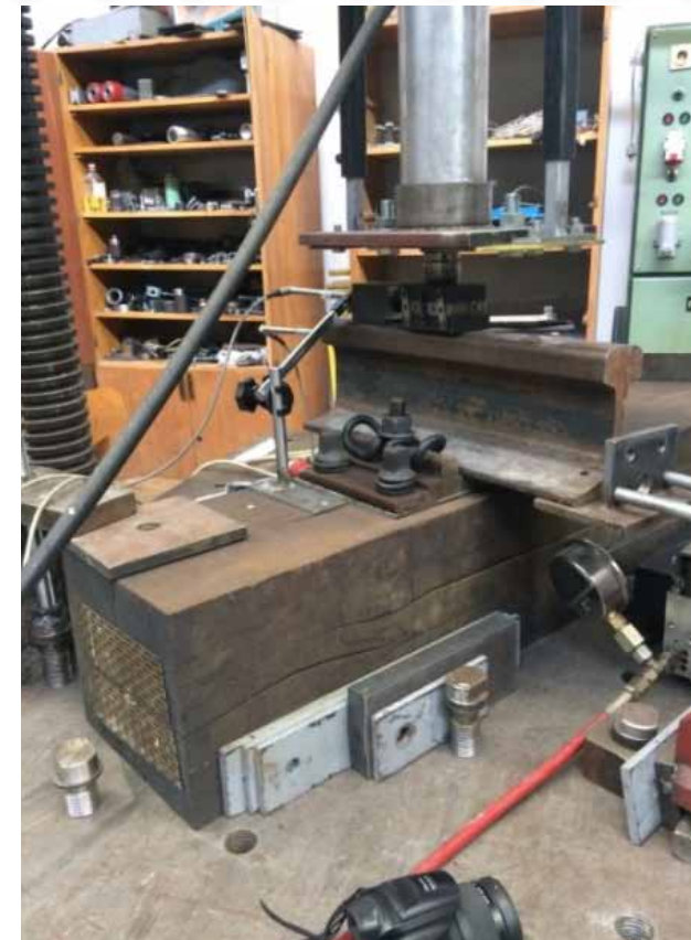
7. ábra: Hosszirányú rugalmasság mérése faaljon
