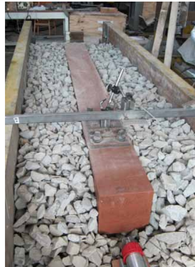
6. ábra: FFU alj ágyazati ellenállásának mérése
