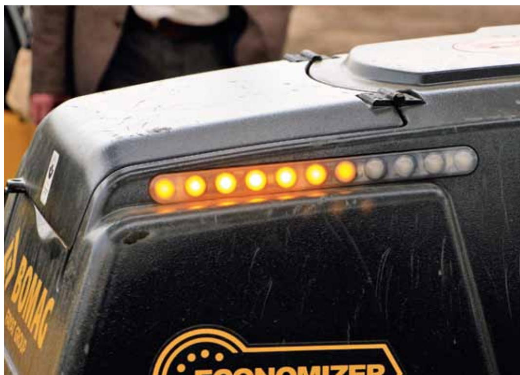
Led lámpasor a tömörség becslésére. Kalibráció esetén pontos visszajelzést ad
