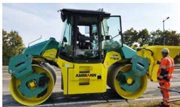
4. kép: Száraz tömörítés, acélköpenyes palástú úthenger (fűtött palástú gumihenger hiányában), zúzalékszóró adapterrel
