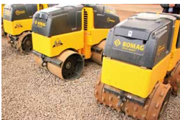
A BOMAG távirányítású, főleg közműárkok visszatöltés tömörítésére tervezett hengerei
