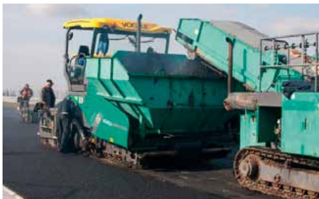
5. kép: az aszfaltkeverék előadagoló segítségével került a finisherek puttanyába
