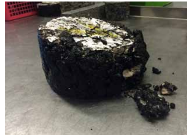
8. ábra: Tönkrement próbatest triaxiális vizsgálat után (4%-os bitumentartalom)
