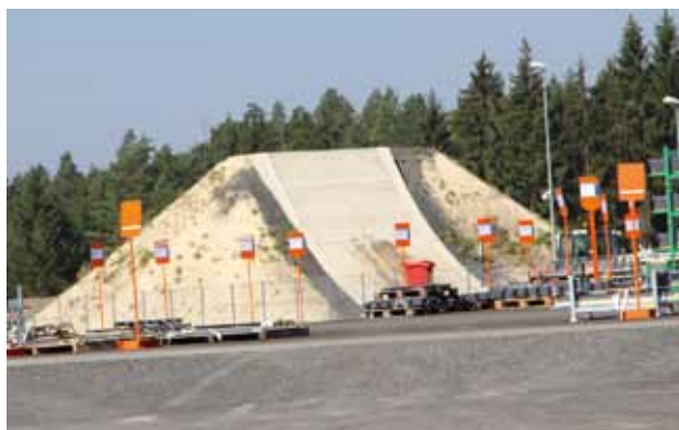
HAMM nyúzó pálya távirányított hengerekkel
