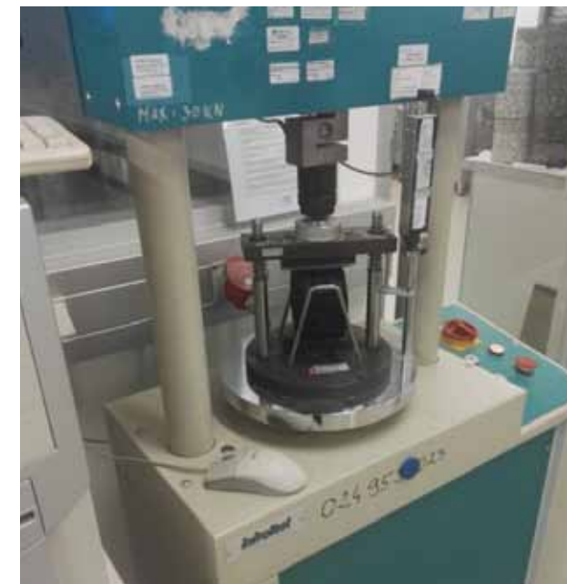
1.kép:a hasító húzó-szilárdság vizsgálata
