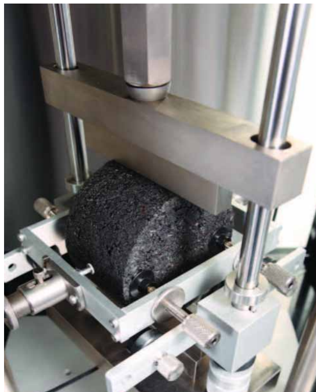
2.kép : a hasító húzó vizsgálat
