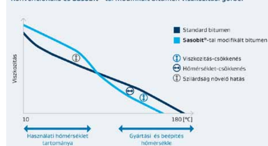
Konvencionális és Sasobit®-tal modifikált bitumen viszkozitási görbéi
