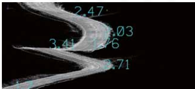
8-2. ábra Az IRI értékek megjelenése a vizsgált úton kapott 3D pontfelhőn [forrás: saját szerkesztés]
