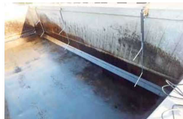
1. kép: Félpótkocsi oldalfalára szerelt hőmérők
