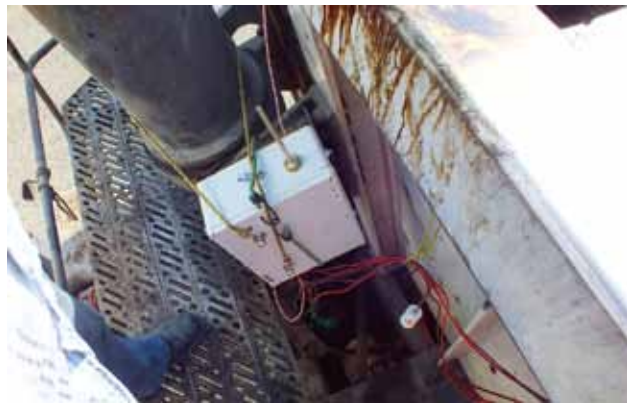
5. kép: Jelenleg használt adatgyűjtő egység és a külső léghőmérsékletmérő
