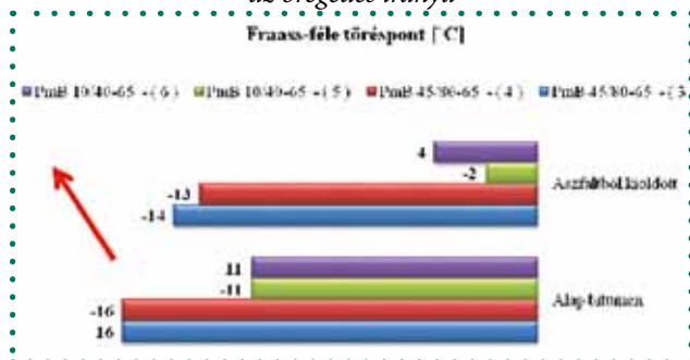
5. ábra: A modifikált bitumenek Fraass-féle töréspontjainak változása alapvizsgálatok, és az aszfaltból kioldás után, és az öregedés irányba
