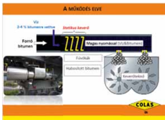
4. ábra: Habosított bitumen előállítása
